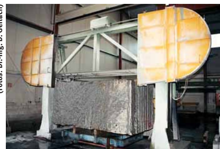
Bild 2: Die nach Selmsdorf umgesetzte Arbes-Seilsäge DSS 208 wird seit 1975 eingesetzt.
