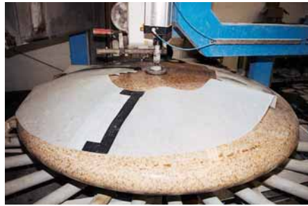
Bild 4: Ein in China vorgefertigter Granit-Ellipsoid wird bei Rechtglaub-Wolf mit einer Vertikalseilsäge und nachfolgender Steinmetzarbeit fertig gestellt.
