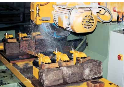
Bild 6: Vorrichtung von Arbes zum Absägen der Köpfe gebrachter Großpflastersteine.
