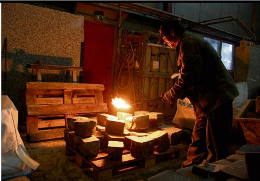
**Oben:** Steinmetz Roland Haase beim Abflämmen von Pflastersteinen. So wird das Material recycelt.
